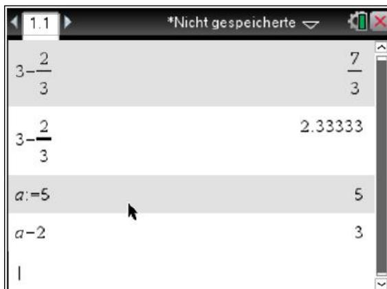
Normalerweise rechnet der GTR immer genau mit Brüchen (1. Zeile). Möchte man eine numerische Näherung („Fließkommazahl“) so muss man statt [enter] nun [ctrl][enter] für „ungefähr gleich“ drücken (2. Zeile).
